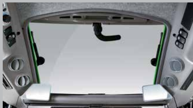
Różne wersje dachu kabiny: szyberdach bez lub ze strukturą wzmacniającą FOPS oraz dach bez szyberdachu, bez lub ze strukturą FOPS.
