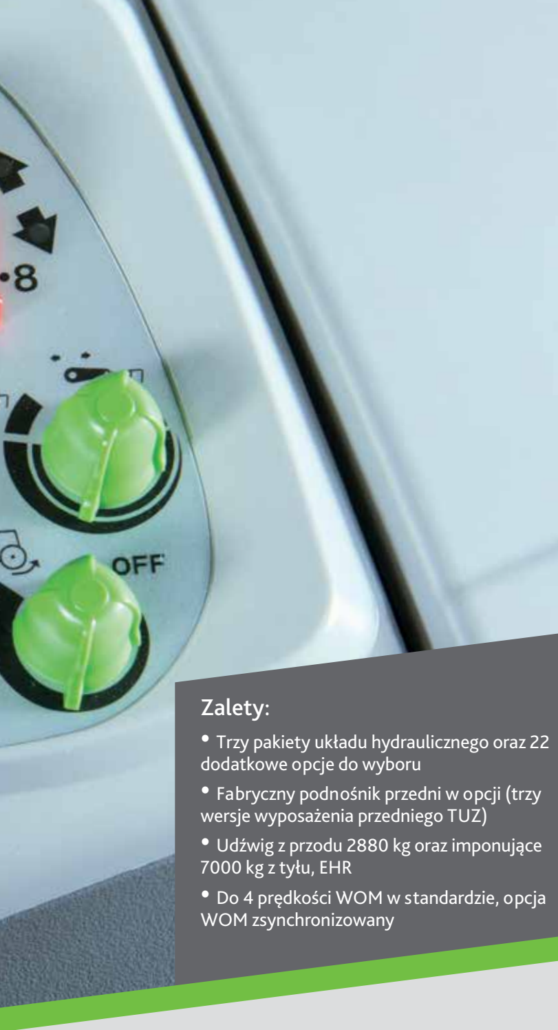
Mechaniczne sterowanie obwodami hydrauliki. Opcjonalne sterowanie elektroniczne.
