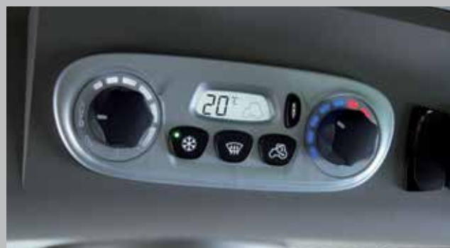
Wybór pomiędzy manualną lub automatyczną klimatyzacją. Panel sterowania klimatyzacji z pokrętlami i przyciskami umieszczony pod dachem kabiny.
