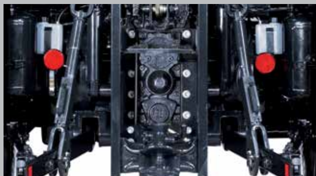
Maksymalnie 4 prędkości wałka z tyłu, funkcja AutoWOM, przedni WOM o prędkości 1000 obr/min jako opcja wyposażenia
