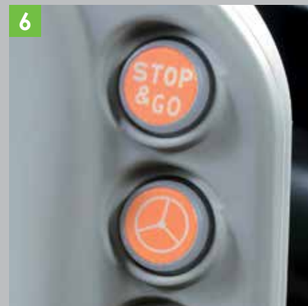
6 Funkcja Stop&Go i układ kierowniczy SDD do szybkiego manewrowania.
