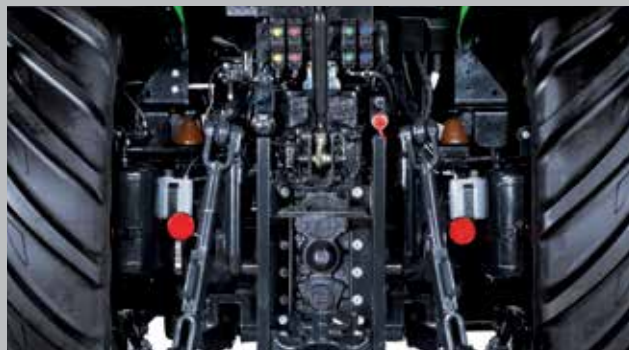
Imponujący udźwig tylnego podnośnika 7000 kg, sterowanie elektroniczne w standardzie.
