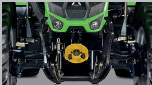
Mocny podnośnik przedni o udźwigu 2880 kg oraz opcjonalny pakiet Comfort z jednym obwodem hydrauliki.
