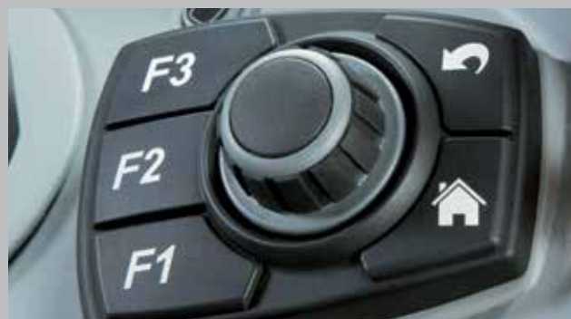
Konsola MMI do sterowania funkcjami monitora. Ułatwia obsługę funkcji w trakcie jazdy po nierównym terenie.
