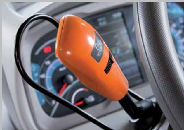
Rewers elektrohydrauliczny Powershuttle ze sprzęgłami SenseClutch umożliwia zmianę kierunku jazdy bez przerywania napędu.
