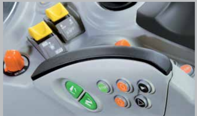
Wszystkie kluczowe funkcje ciągnika sterowane przełącznikami zgrupowanymi na prawej konsoli.
