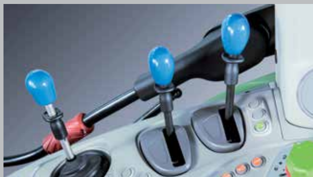
Mechaniczne sterowanie obwodami hydrauliki. Opcjonalne sterowanie elektroniczne.
