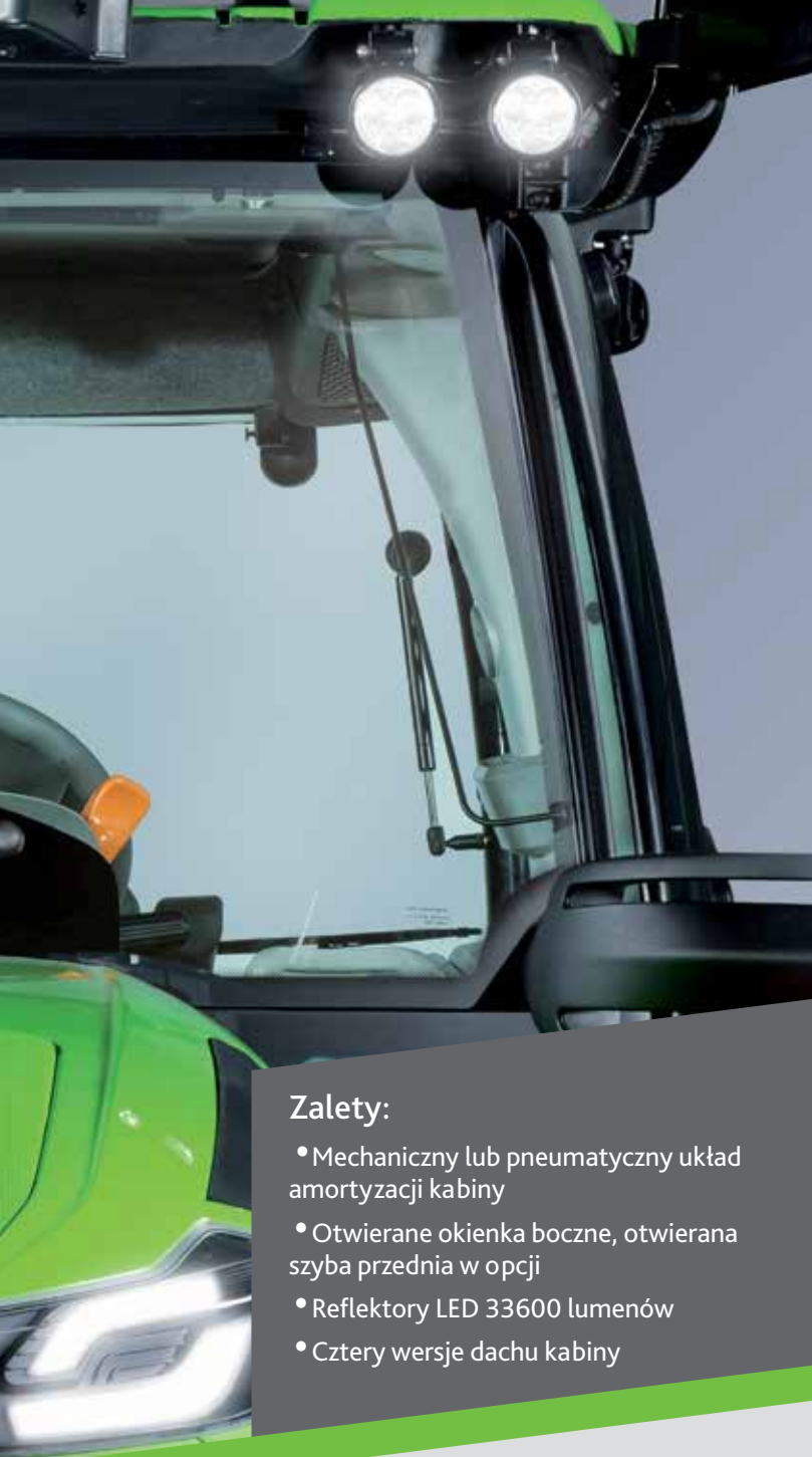
Różne wersje dachu kabiny: szyberdach bez lub ze strukturą wzmacniającą FOPS oraz dach bez szyberdachu, bez lub ze strukturą FOPS.
