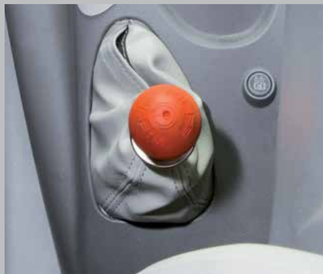
Hydrauliczny hamulec postojowy Park Brake. Obok hamulca przycisk do testu układu pneumatycznego przyczep - zgodnie z najnowszymi wytycznymi Mother Regulation UE.
