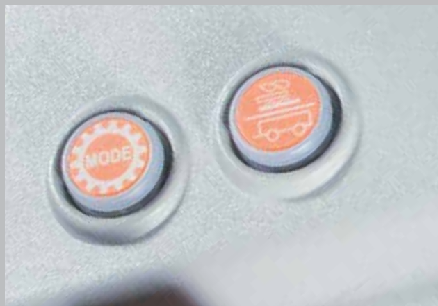
Zakresy prędkości (POLE/TRANSPORT) są zmieniane elektrohydraulicznie przyciskiem i mogą być zmieniane w trakcie jazdy do prędkości 15 km/h.
